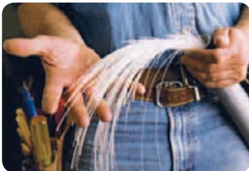
La aplicación de los principios de reflexión y refracción de la luz han hecho posible el uso de la fibra óptica en las comunicaciones.
